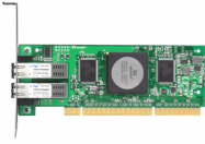
connecteur PCI-X 2.0 64 bits
